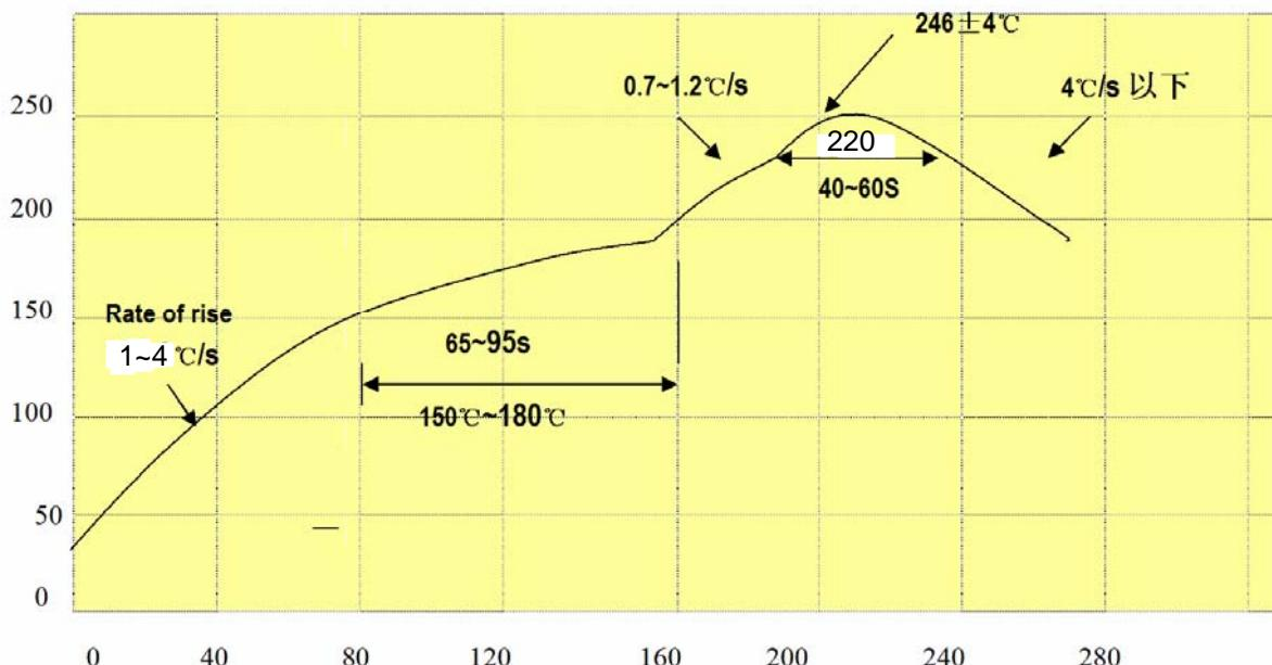
上述推荐的回流曲线适用于大多数锡/银/铜 (SAC0307) 合金的无铅锡膏，在使用 Sn99/Ag0.3/Cu0.7 时，可把它作为建立回流工作曲线的参考，最佳的回焊曲线要根据具体的工序要求（包括：线路板的尺寸、厚度、密度）来设定的，它有可能是偏离此推荐值的。
